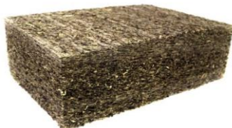
Figur 5: Ålegræs som isoleringsmåtte - https://www.zostera.dk/
